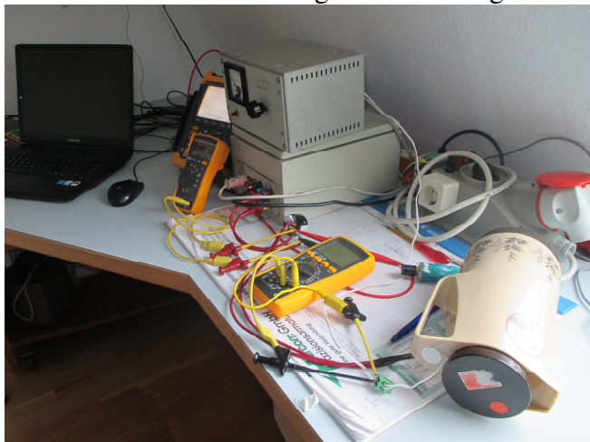
Bild 12: Versuch mit sehr guter Dämmung um den Heizwiderstand, in Form einer Thermoskanne.
