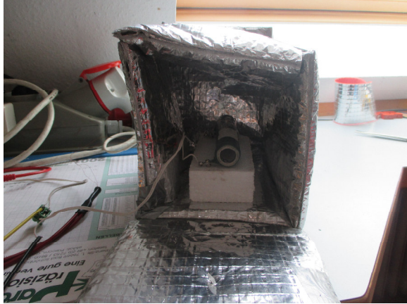
Bild 3: Lupotherm- Gehäuse, Maßstab 1:15, als Nachbildung zu einem Raum mit Innendämmung, mit Heizwiderstand innen, mit offenem Deckel.
