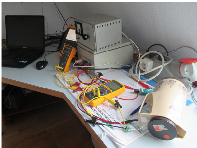
Bild 6: Lupothversuchsaufbau.jpg Versuch mit sehr guter Dämmung um den Heizwiderstand, in Form einer Thermoskanne.
