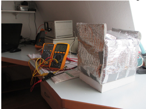
Bild 4: Lupotherm- Gehäuse, Maßstab 1:15, als Nachbildung von einem Raum, mit Heizwiderstand innen, mit beim Versuch geschlossenen Deckel.
