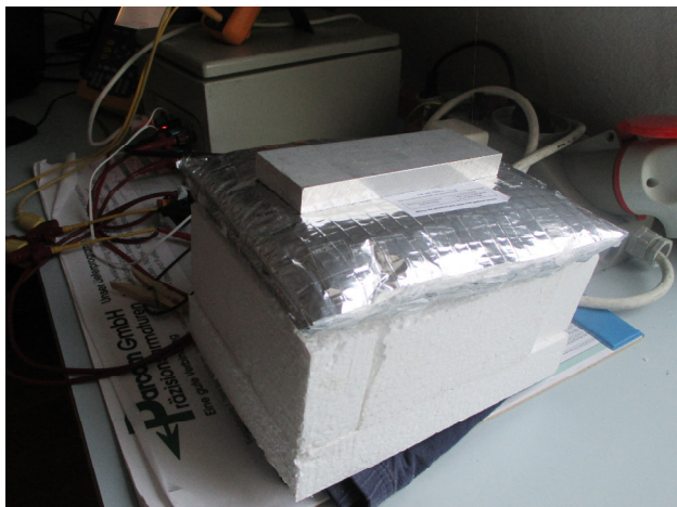
Bild 11: Lupothversuch6.jpg Heizwiderstand im Styroporkasten mit Lupothermkissen als Deckel.
