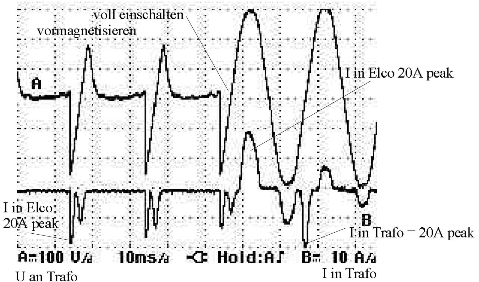
16 A B-Automat löst nicht aus, Trafoeinschaltstromstoß
